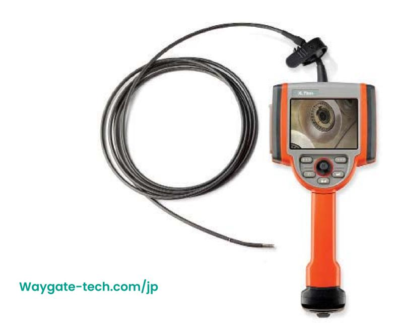
XL FlexおよびXL Flex+ビデオスコープは4GB内部メモリ、3.7インチディスプレイのXL Flexおよび 16GB内部メモリ5インチディスプレイを搭載したXL Flex+をラインナップに加えることで、卓越した画像品質とパワフルなLCDの発光出力により欠陥検出能力(POD)を向上、そして欠陥を詳細に測定するステレオ計測により、検査作業の分析、効率の向上をもたらします。軽量で持ち運びが簡単で使いやすいにもかかわらず、高い耐久性を持つデザインは、ユーザー様のメンテナンスコストの削減を実現します。
